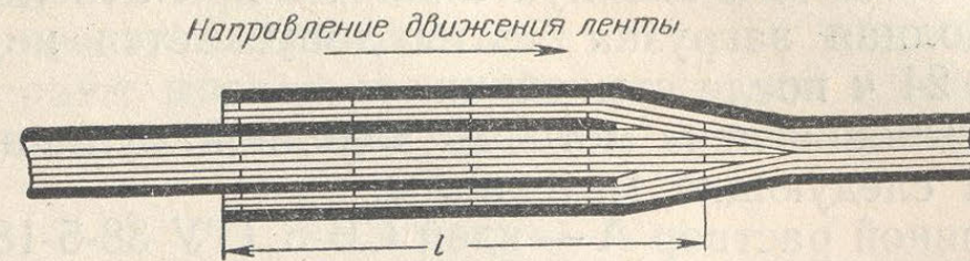
Рис. 17. Соединение концов ленты в паз.
