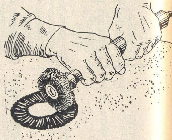
Рис. 31. Шероховка поврежденного места обкладки ленты.
